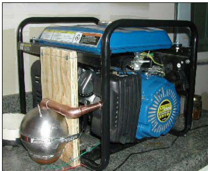
Moe-Joe cell gemonteerd op een generator 33
